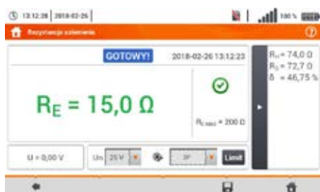
Měření odporu uzemnění
