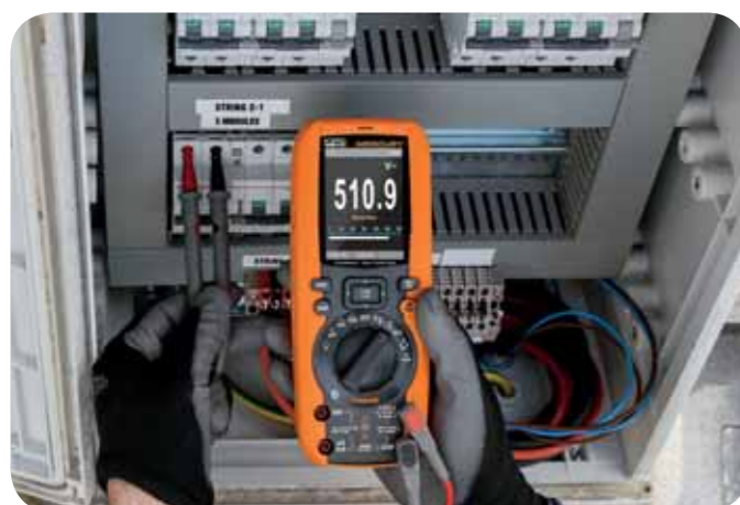
FV string Voc měření
