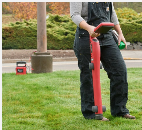
Trasování konkrétního kabelu pomocí přímého metalického připojení vysílače
