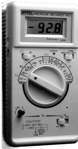
Tester telefonních zařízení a linek TLS 2000ME měří stejnosměrná a střídavá linková napětí, proudy a odpory, umožňuje provádět NF měření v pásmu do 20kHz. Impedance vysílače a přijímače je volitelná (600 nebo 900Ohm, u přijímače ještě 1MW). Připojení k lince je konektorem RJ 11 nebo konektorem "jack". Napájení přístroje zajišťuje 9V baterie, naměřené hodnoty jsou zobrazeny na displeji 3 1/2 digit.
